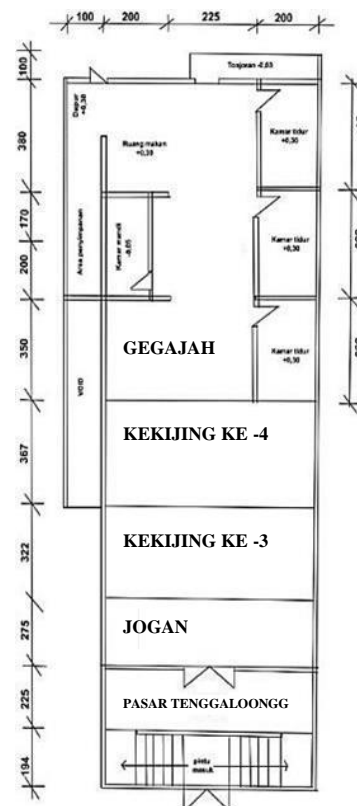
Gambar 8. Perbedaan ketinggian lantai pada rumah limas Kampung Firma (Sumber: Dokumentasi Pribadi)
