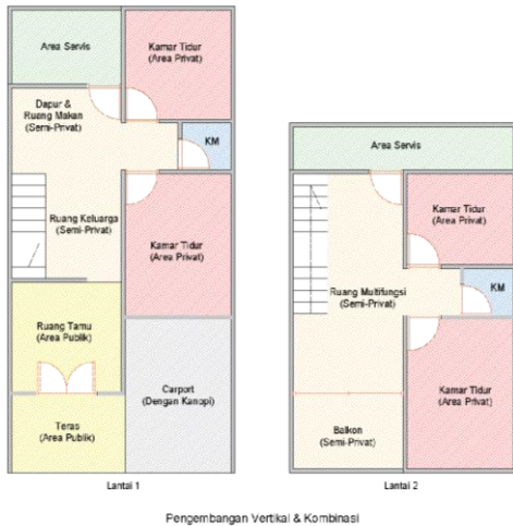
Gambar 4. Skema denah sesudah pengembangan vertikal & kombinasi. Sumber: Data Pribadi, 2025
