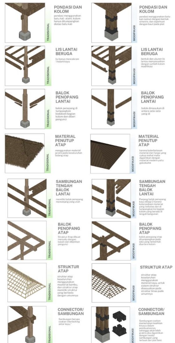
Gambar 4. Perbandingan Bagian Struktur Berugaq Tradisional dan Modifikasi. Sumber: Penulis 2025
