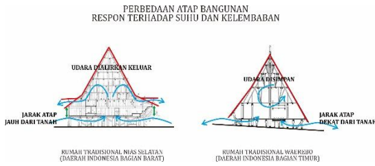
Gambar 5. Ekspresi Bentuk Atap Bangunan Sebagai Respon Suhu dan Kelembaban (Sumber : Analisis Peneliti, 2016)
