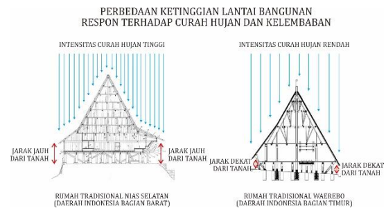
Gambar 6. Ekspresi Lantai Bangunan Sebagai Respon Curah Hujan dan Kelembaban (Sumber : Analisis Peneliti, 2016)
