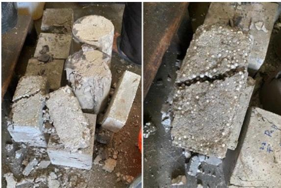
**Gambar 10. Hasil Pengujian Menggunakan Compressive Strength**
