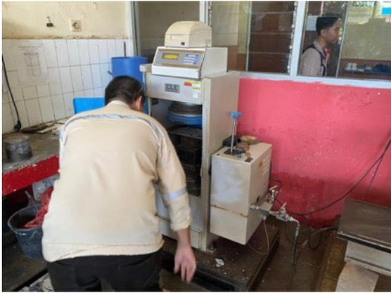
**Gambar 9. Proses Pengujian Menggunakan Compressive Strength**
