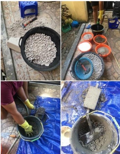
Gambar 6. Proses Pembuatan Sampel Uji (*Eco-brick*)
