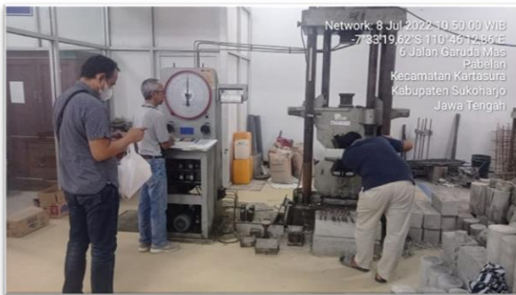
Gambar 12 Pengecekan Mutu Baja di Labratorium Pembangunan Gedung Kantor Permanen-Pembangunan Gedung Kebudayaan
