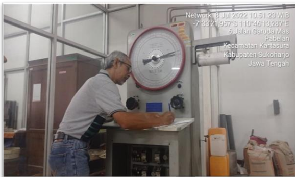
Gambar 12 Pengecekan Mutu Baja di Labratorium Pembangunan Gedung Kantor Permanen-Pembangunan Gedung Kebudayaan
