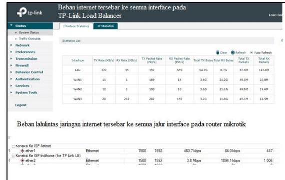
Gambar 12. Hasil Load Balancing Jalur Internet
