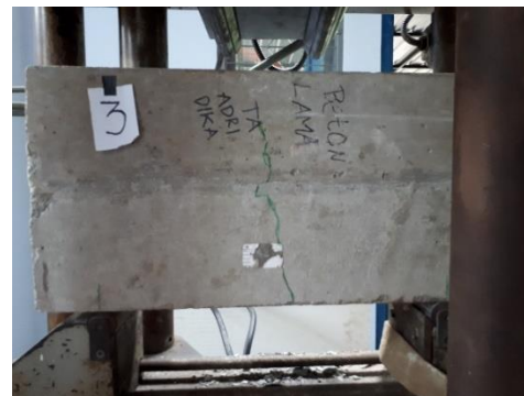
Gambar 9. Pola Retak Balok
