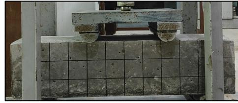
**Gambar 4: *Uncracked Phase* pada Balok Beton BS02**
